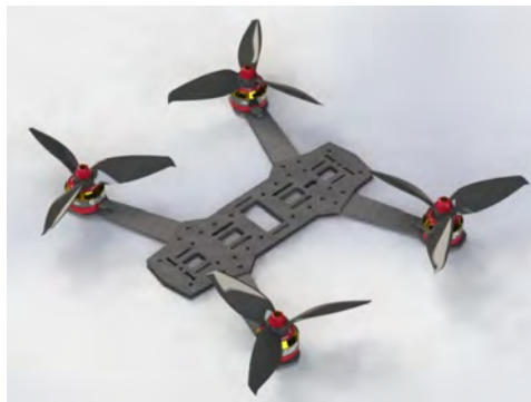
Рис. 1. Модель квадрокоптера, спроектированная в системе SolidWorks
